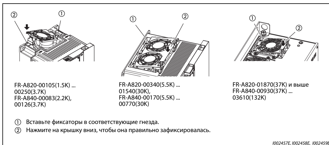
Рис. 7-6: Монтаж кожуха вентилятора
