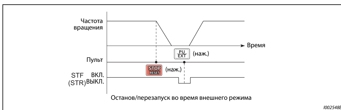
Рис. 5-8: Останов во время внешнего режима управления
