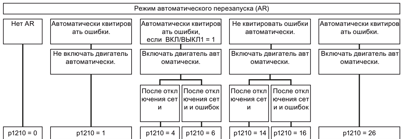
Рис. 8-25 Режимы автоматики повторного включения
