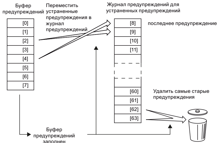
Рис. 11-4 Перемещение устранимых предупреждений в журнал предупреждений
