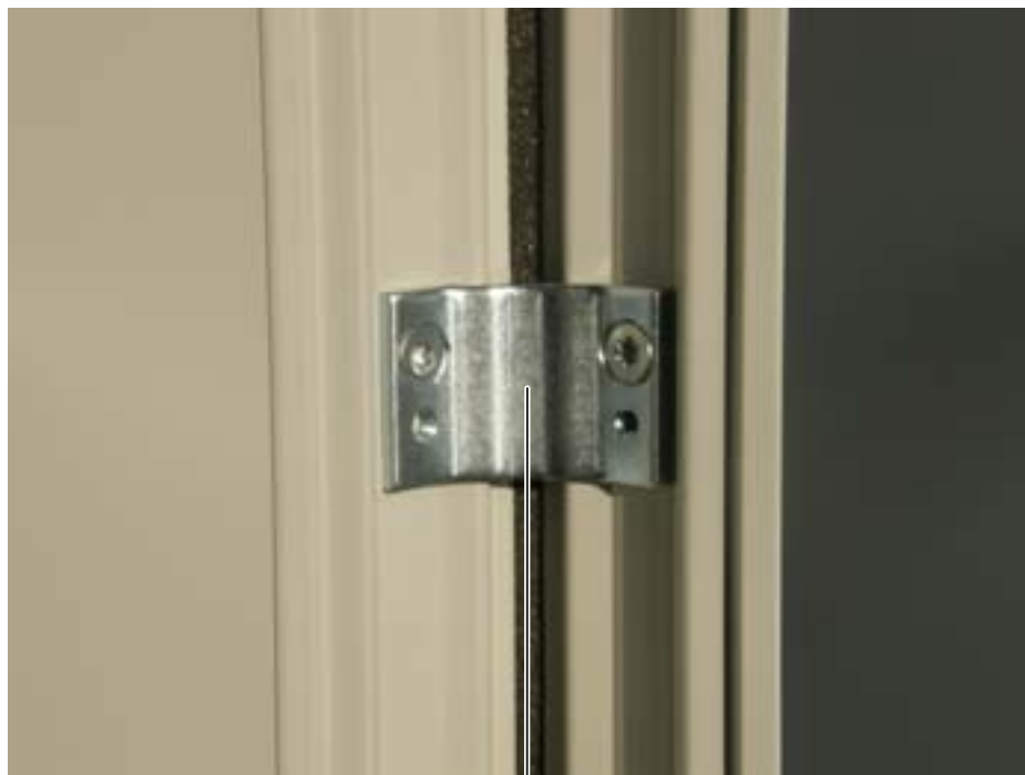
Наружная шкафная стяжка Момент затяжки: 9 Нм
