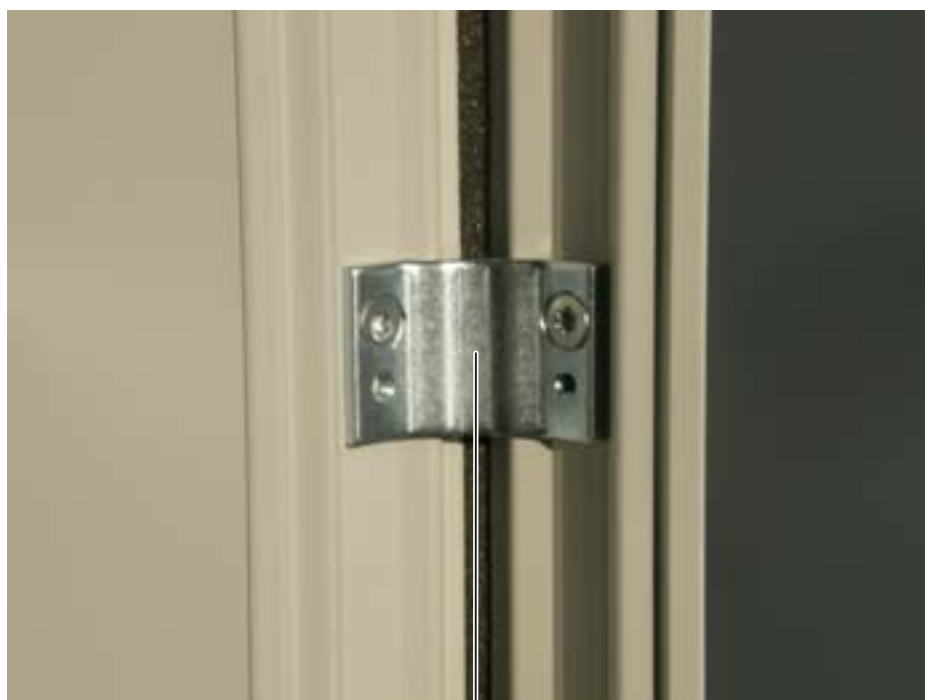
Наружная шкафная стяжка Момент затяжки: 9 Нм
