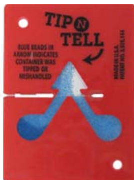
Изображение 3-4 Сработавший индикатор опрокидывания
