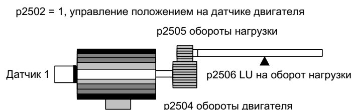
Изображение 9-23 Подготовка фактического значения положения с круговыми датчиками
